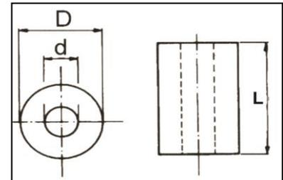
Die Hülsen für M6 Schrauben können auch für M5 Schrauben verwendet werden
