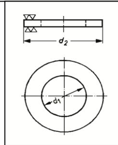
Alle U-Scheiben werden komplett aus Rundmaterial abgedreht
