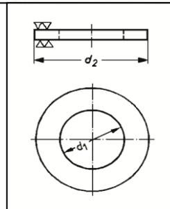
Alle U-Scheiben werden komplett aus Rundmaterial abgedreht
